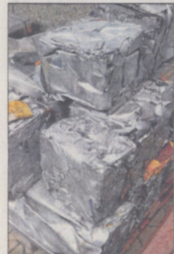
Kompakter Rohstoff: 30 mal 30 Zentimeter messen die Stahlschrott-Pakete.
